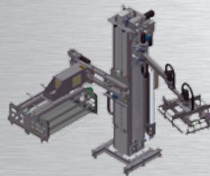
La colonne fixe "3 en 1" reçoit les éléments mécaniques préposés aux opérations de palettisation, alimentation des palettes vides et introduction des intercalaires, c'est-à-dire trois exécutions habituellement réalisées
