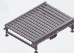
Structure en acier galvanisé et rouleaux  $\varnothing$  76 mm pas 150 mm, motorisés moyennant chaîne de 5/8 de pouce. Motorisation centrale électriquement réversible.
